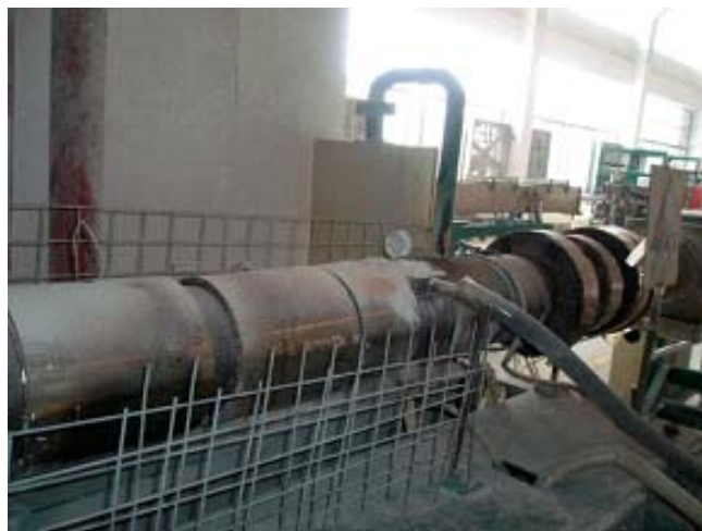
▲流程：由右至左--分段加熱，高壓泵(內藏)，經模具成管狀，冷卻
