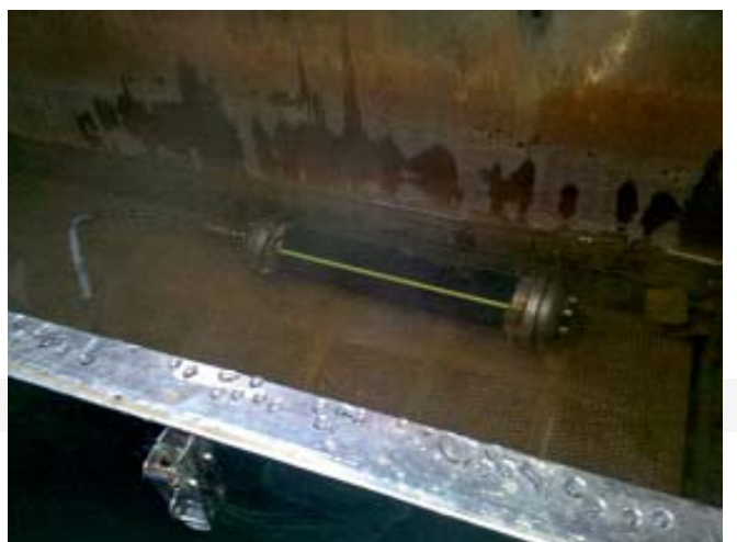
▲重要測試之一：高溫高壓長時間壓力測試
