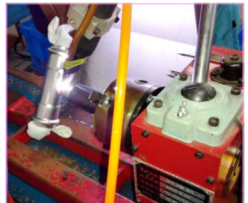
上圖是採用氬氣焊焊合接三通支口，即俗稱鴉雀口焊接
