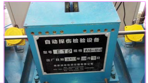
在另一機組上是自動探傷檢測，檢查管壁有否缺陷
