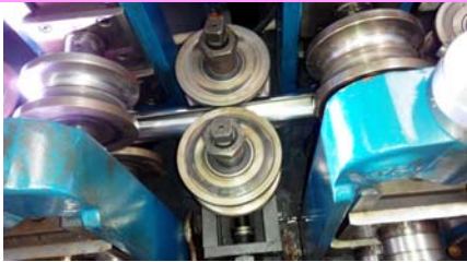
下圖是鋼皮在滾筒擠壓下慢慢成為圓形管子
