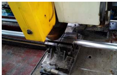
在另一機組上是自動探傷檢測，檢查管壁有否缺陷
